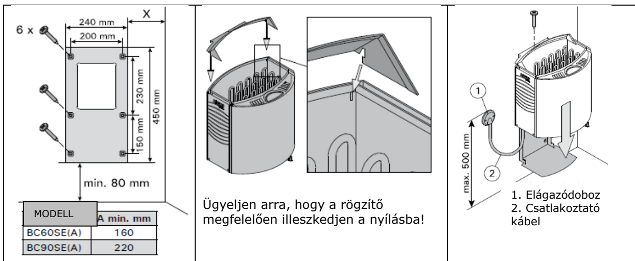
6. ábra A kályha falra történő rögzítése
