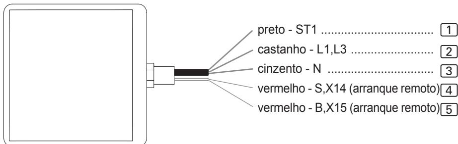
Remover os terminais de cabos pré-montados em função do comando utilizado.
